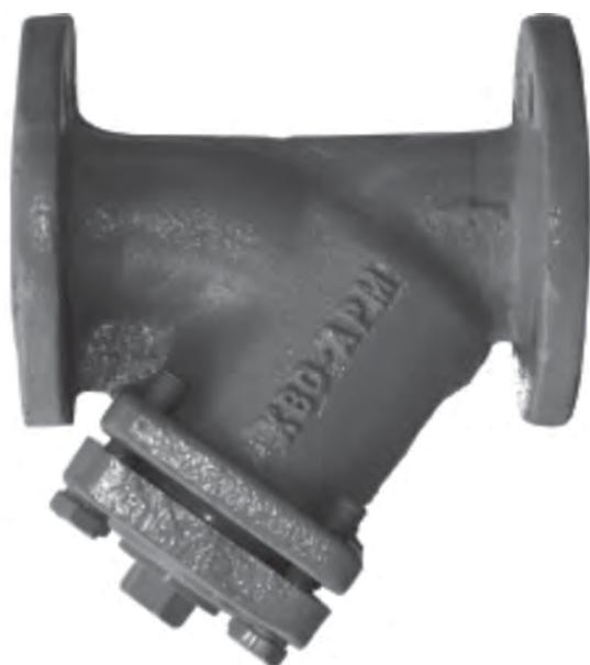
Фильтры предназначены для защиты от засорения инженерных систем стойкими механическими примесями. Фильтр улавливает все твердые частицы, размеры которых превышают размер ячеек сетки (стандартное исполнение сетки: ячейка 1,2 x 1,2 до DN 100мм, ячейка 1,6 x 1,6 от DN 125мм до DN300мм. По требованию заказчика размеры ячеек сетки могут быть любые) В зависимости от условий эксплуатации
