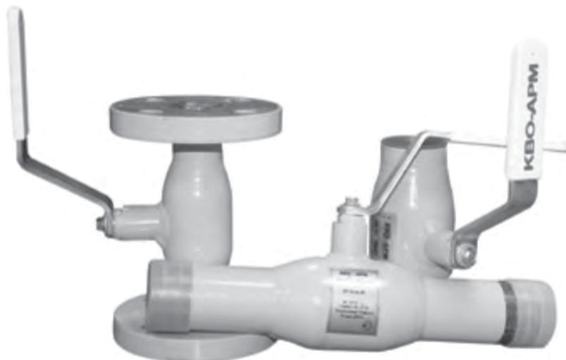
Краны шаровые газовые, изготовленные на нашем предприятии ООО «КВО – АРМ», снабжены антистатическим устройством. Подпружиненные шарики, обеспечивают непрерывный контакт между штоком и шаром, штоком и корпусом штока, это позволяет уменьшить электрическое сопротивление и предотвращает искрение во время поворота штока при открывании и закрывании крана. Снижается риск воспламенения газа при прохождении через трубопровод.
